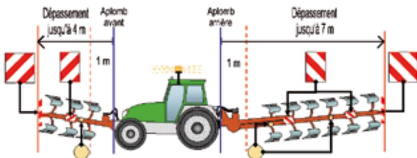
Pour les véhicules isolés dont la longueur dépasse 12 m et pour les ensembles de véhicules dont la longueur dépasse 18 m, j'utilise des catadioptres latéraux ou j'alterne les catadioptres et les feux de position latéraux.
