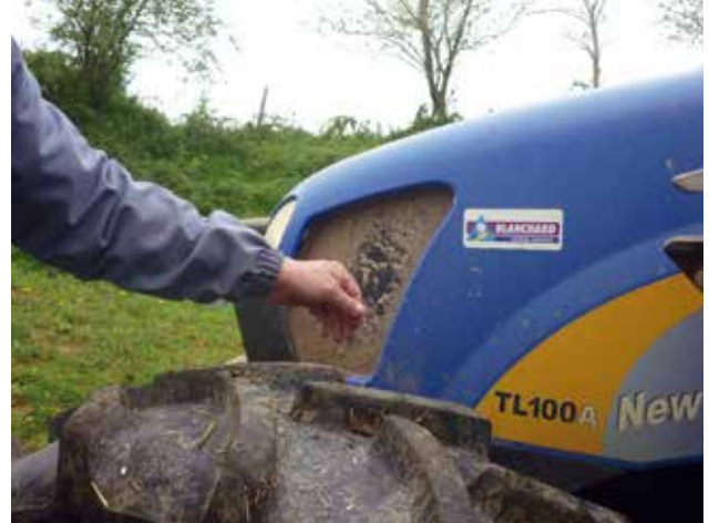
Amas de poussières sur le filtre à air
