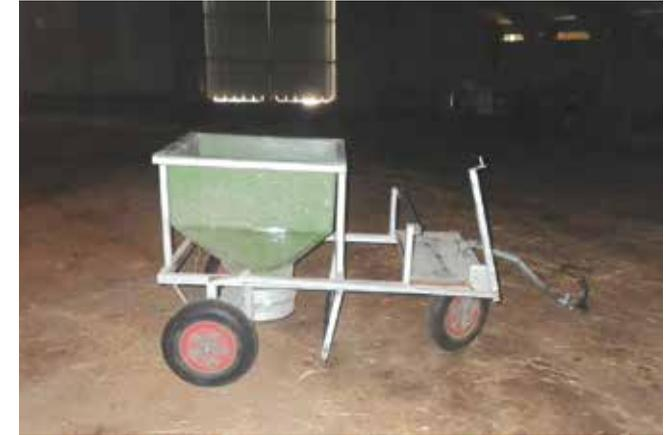
La mise en place de ce type de chariot permet de distribuer mécaniquement et sans manutention l'aliment nécessaire au démarrage de la production. Le chariot déroule le papier puis distribue l'aliment sur celui-ci. Idéalement placé derrière un quad le chariot permet une **suppression de manipulation d'environ 1 500 kg d'aliment manipulés par bâtiment.**
