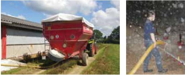
La souffleuse de paille (ou copeaux) supprime toutes les manutentions manuelles lors des tâches de paillage en cours de production. Le tuyau de distribution est fixé sur un rail au plafond. L'opérateur n'a donc aucun élément à porter, il lui suffit de diriger le tuyau vers les zones à pailler.
