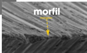
**Morfil** : particules d'acier apparaissant sur la crête du taillant lors de l'affûtage.
