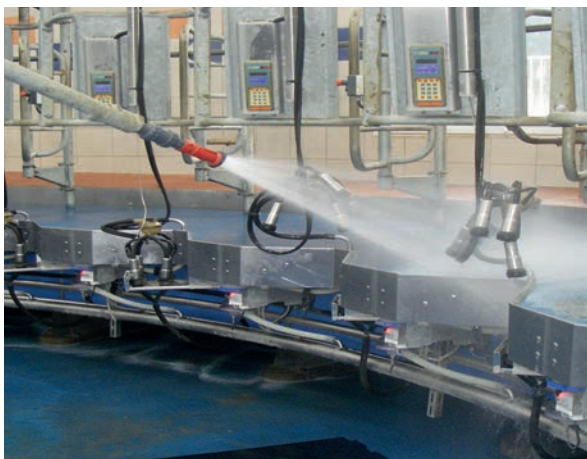
Lavage du manège par rampe fixe.
