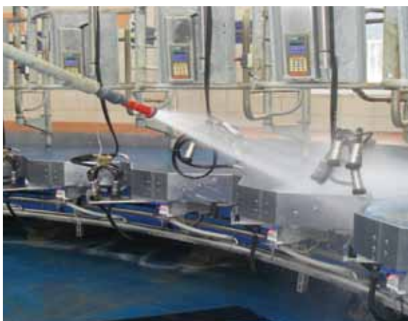
Lavage du manège par rampe fixe.
